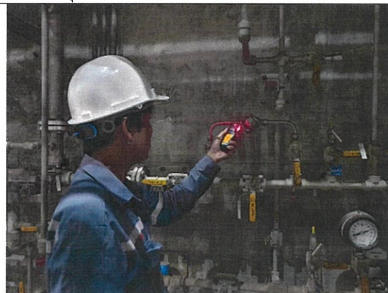
Operator ตรวจวัดการรั่วไหลของก๊าซไฮโดรเจน ภายหลังจาก หยุดการรั่วไหลของก๊าซไฮโดรเจนได้สำเร็จ
